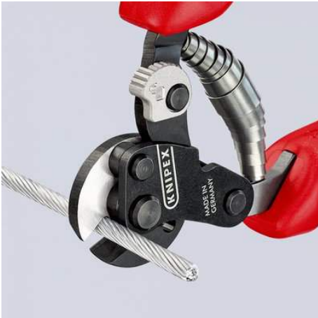
Schneiden von hochfesten Drahtseilen (1960 N/mm 2 ) bis 4 mm Ø
