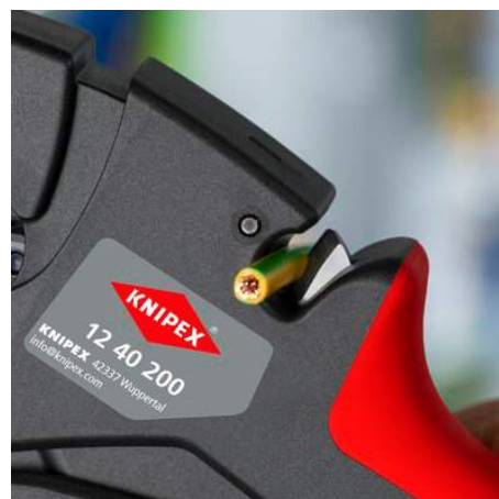
Integrierter Kabelschneider bis 10 mm 2 feindrähtig, 6mm 2 eindrähtig
