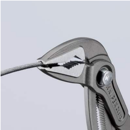
Lange, spitze Backen mit Frontgreif-Verzahnung: längs eingebrachtes Greifprofil für Rundteile wie Schrauben und Bolzen sicherer Griff auch an Flachteilen durch Dreipunktauflage
